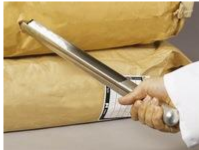
Εικόνα 3: Συλλογή δείγματος από σακί με αλεύρι με χρήση μονής σόντας (Πηγή: https://www.ddbiolab.com/frontoffice/article/114499 )
